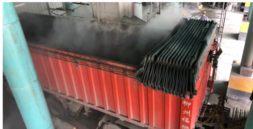
红水河水泥骨料仓下料口干雾降尘
