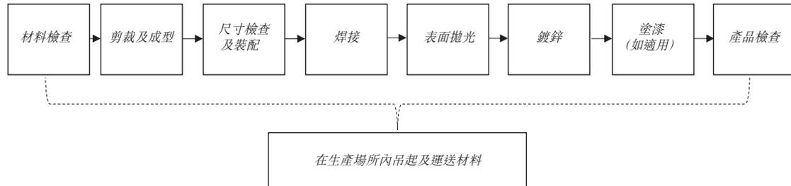
除材料檢查由本集團及香港及中國客戶指定代表進行外，我們的結構鋼產品的製造程序均在中國進行。我們用自身勞工進行內部結構鋼製造。同時，我們委聘中國分包商對需要專業技術技能的結構鋼進行鍍鋅工作。根據我們的產能，我們亦可能將結構鋼製造工程的其他部分外判予中國分包商。
