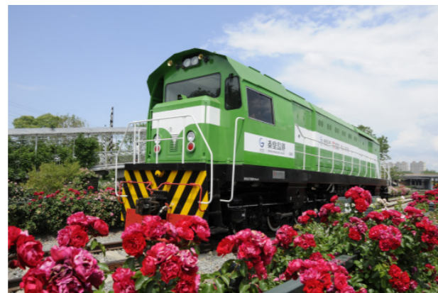
国内首台由旧内燃机车改造而成的纯电动调车机车
