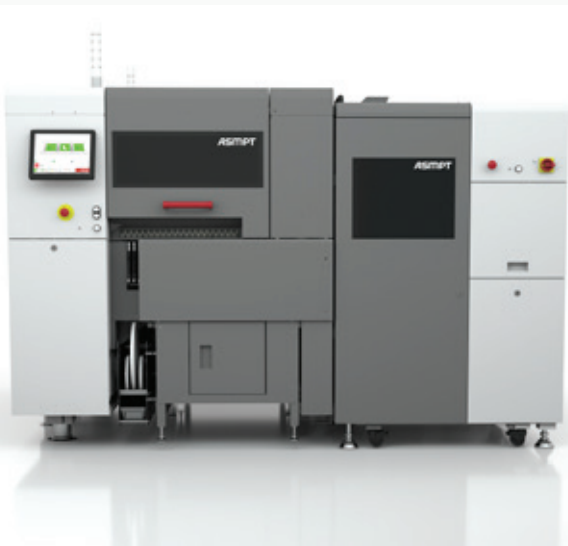
SIPLACE CA混合貼片機亦可直接從預剝離的晶圓中放置元件，避免大量的膠片浪費。
