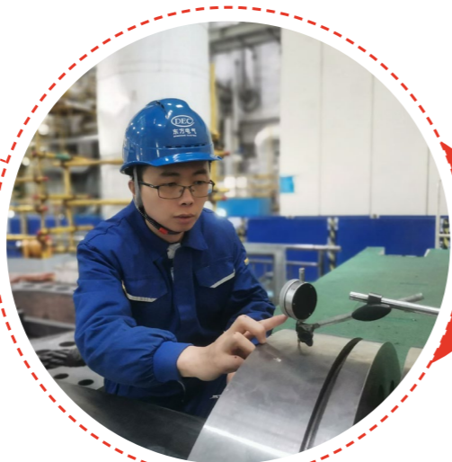
东方汽轮机的电站服务人员正在进行发电机组的精益检修
