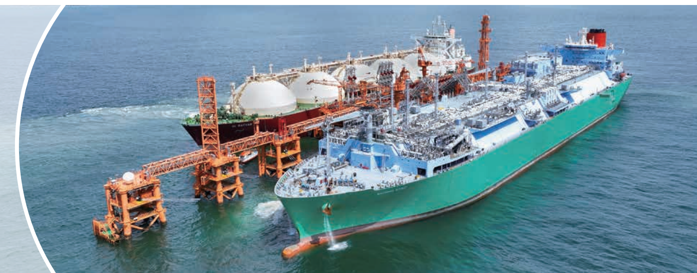
一艘運載液化天然氣的貨船（左方）抵達香港首個海上液化天然氣接收站，將液化天然氣卸載至浮式儲存再氣化裝置船「紫荊精神號」（右方）進行再氣化。
