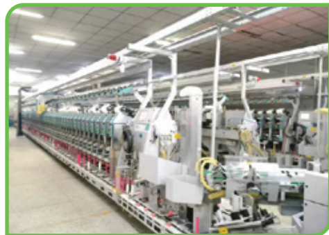
5G automatic winding machine of Changzhou subsidiary 常州子公司5G自動絡筒機
