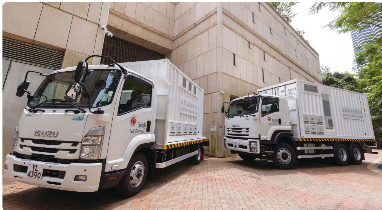
綠色流動供電系統由儲能卡車(右)和電源轉換卡車(左)組成，在無法正常供電時提供不間斷的臨時電力。
