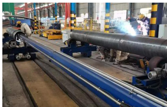
內環焊接設備
