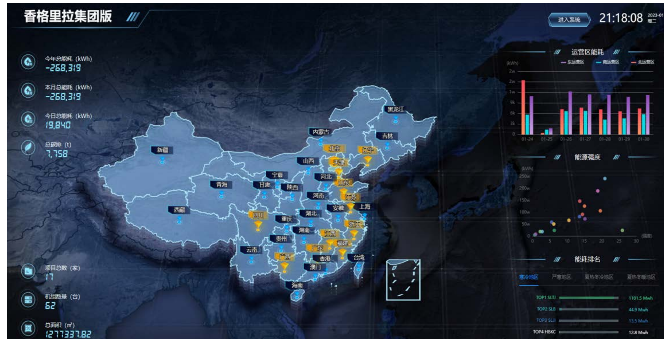
智能建築管理系統(IBMS)儀錶盤，促進建築管理智能化及數字化
