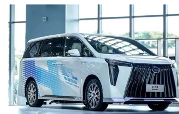
行業首款搭載氫氣發動機的氫混整車——傳祺 E9 氫混版
