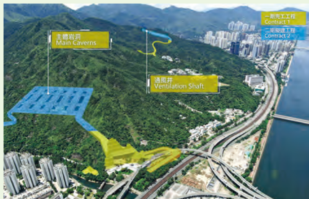
搬遷沙田污水處理廠往岩洞－主體岩洞建造工程
