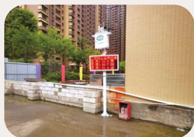
揚塵監測設備
