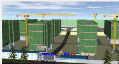
濟南槐蔭項目應用 BIM 技術對施工現場進行場地布置，使施工現場平面布置可視化
