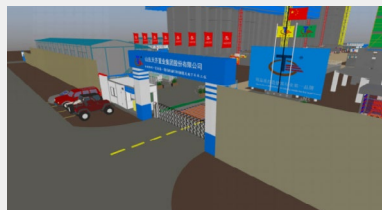
濟南槐蔭項目應用 BIM 技術對施工現場進行場地布置，使施工現場平面布置可視化
