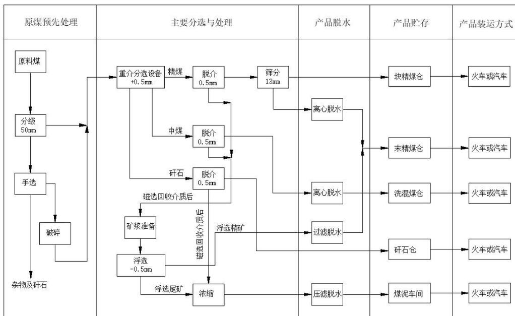
经井工、露天开采出的原料煤，运输至地面选煤厂洗选系统进行加工处理。原料煤预先进入分级筛进行分级，大于规定粒级的筛上物料经人工捡杂后进入破碎机，破碎至规定粒度以下，与原煤分级筛筛下原煤混合后，一起进入重介分选工艺系统和浮选工艺系统进行洗选。重介洗选系统分选出的精煤、中煤、矸石经脱介、脱水后成为最终产品，其中，重介精煤可根据需要进行二次分级筛分，成为块精煤和末精煤两种产品，并分别进入各自产品仓存储。小于 0.5mm 细粒级末煤经浮选工艺系统分选后，产出浮选精矿和浮选尾矿，浮选精矿经过滤脱水后，进入末精煤产品仓存储；浮选尾矿经浓缩、压滤脱水处理后，最终成为煤泥产品。
