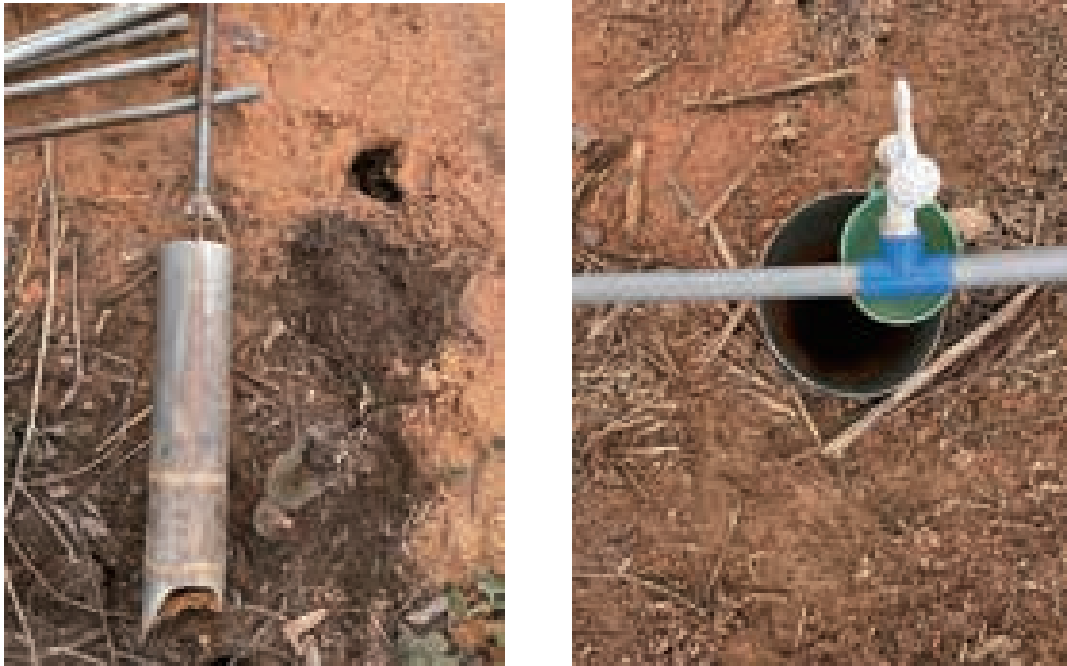
圖12-6：鑽孔及注液孔
