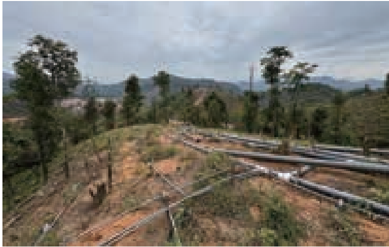
圖11-2：山頂的原地注液系統
