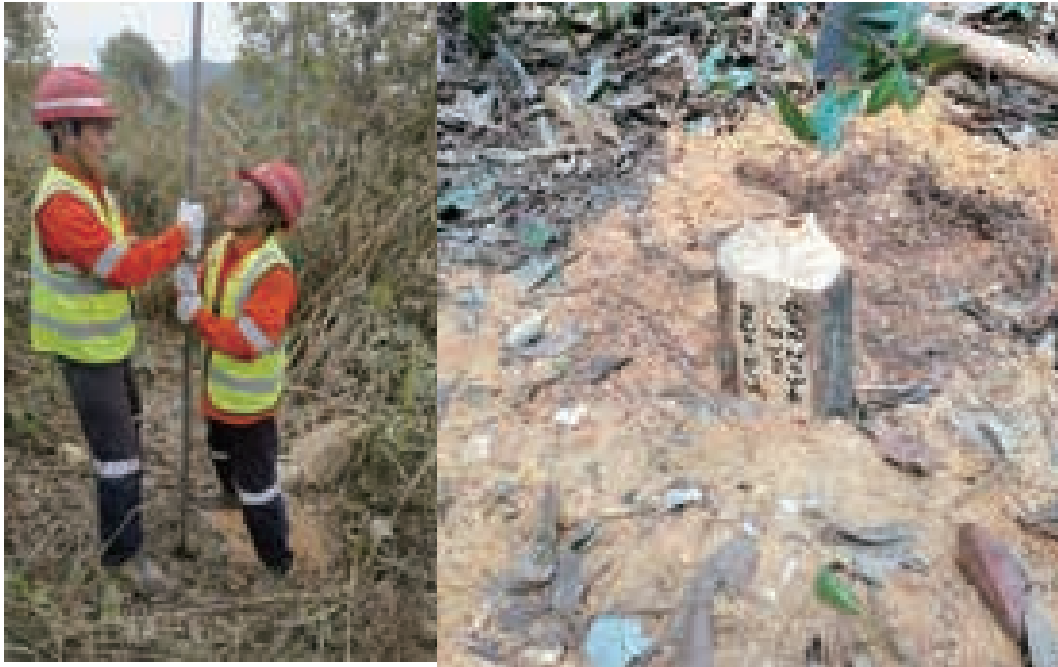
圖7-3：GN螺旋鑽的利用及封孔
