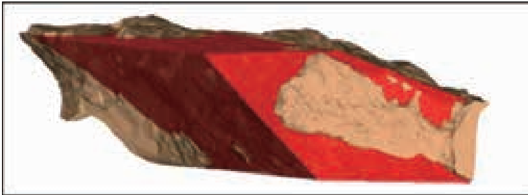
圖11-10: 超挖及欠挖分析
