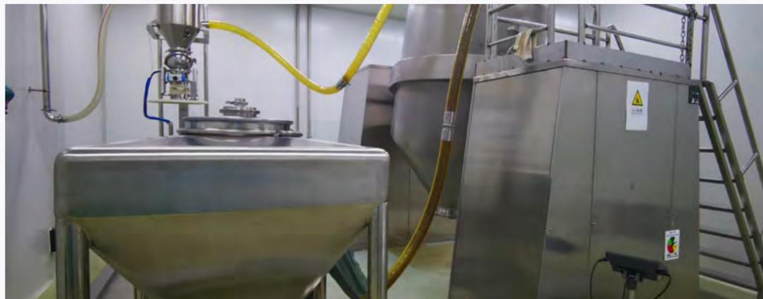
上药国风使用密闭转运小车代替原来的流化床设备的物料转运的塑料桶。引入物料密闭转运车与流化床、混料机进行对接，出料、运输、称量、混料全程在密闭转运车及附属管道内进行，实现对尘源的隔离、密闭；同时对真空上料系统进行设备升级，将声源移出作业场所，实现对噪声的有效控制，同时降低了劳动过程中人员劳动强度。
