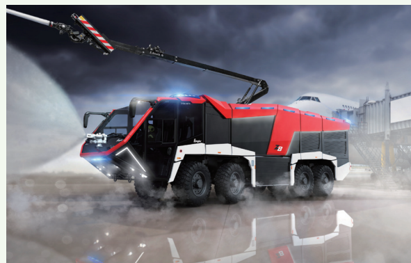
▲ 國產混動8X8機場消防車整車造型對標齊格勒Z8設計
