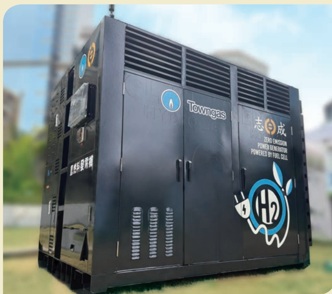
集團與能源設備公司合作，開發氫能發電模組，為建築地盤等場景提供新能源發電一體化解決方案。
